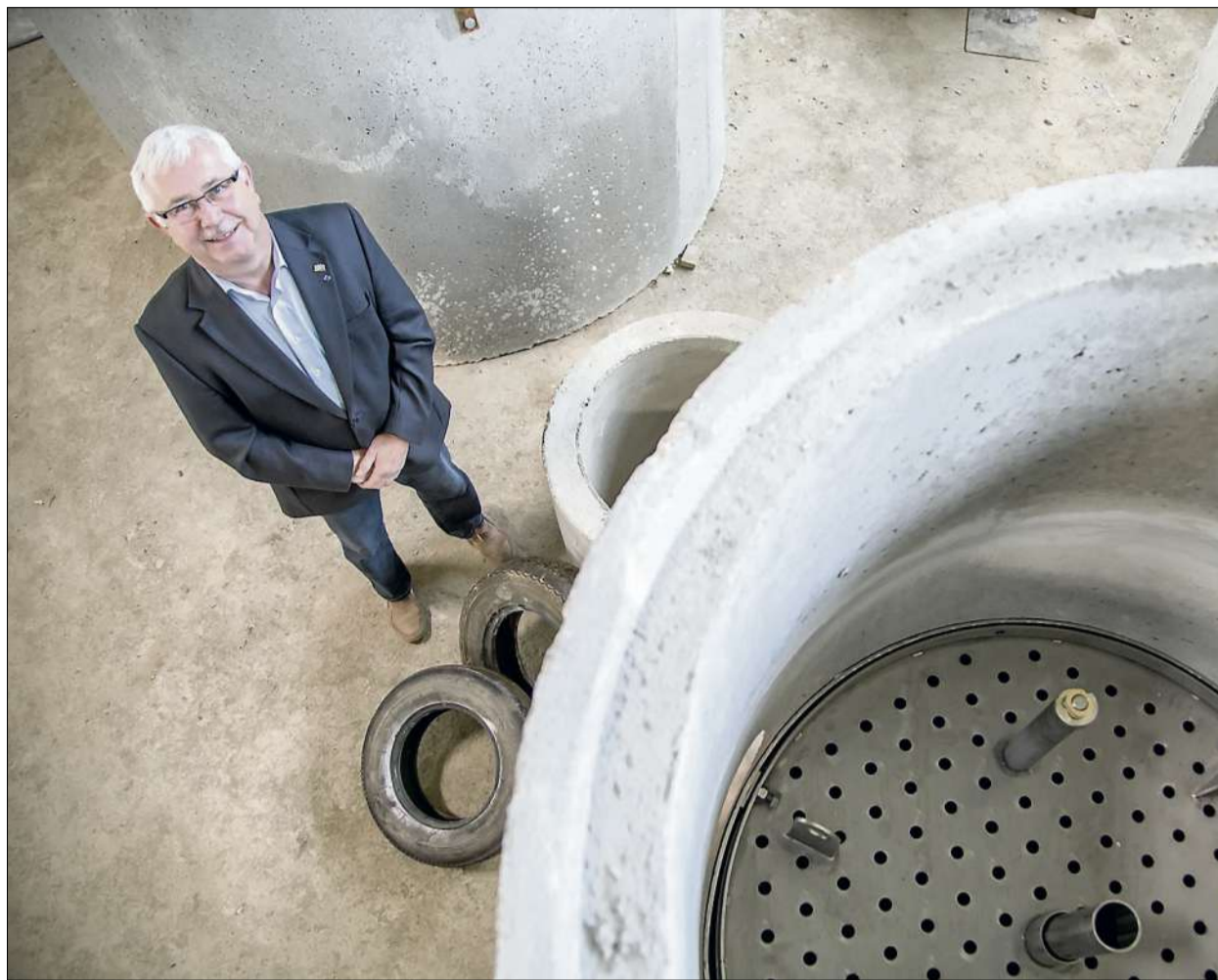
Johann Schmidtschneider hat mit einem Team der Firma Lauterbach-Kießling einen Regenwasserfilter entwickelt, der aus recycelten Altreifen hergestellt wird.
