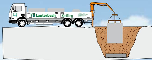
Sämtliche Regenwassersammelschächte (mit Ausnahme des 15 m<sup>3</sup> Monolithschachtes) können direkt vom LKW in die Baugrube gesetzt werden, wenn eine einwandfreie Zufahrt gegeben ist.
