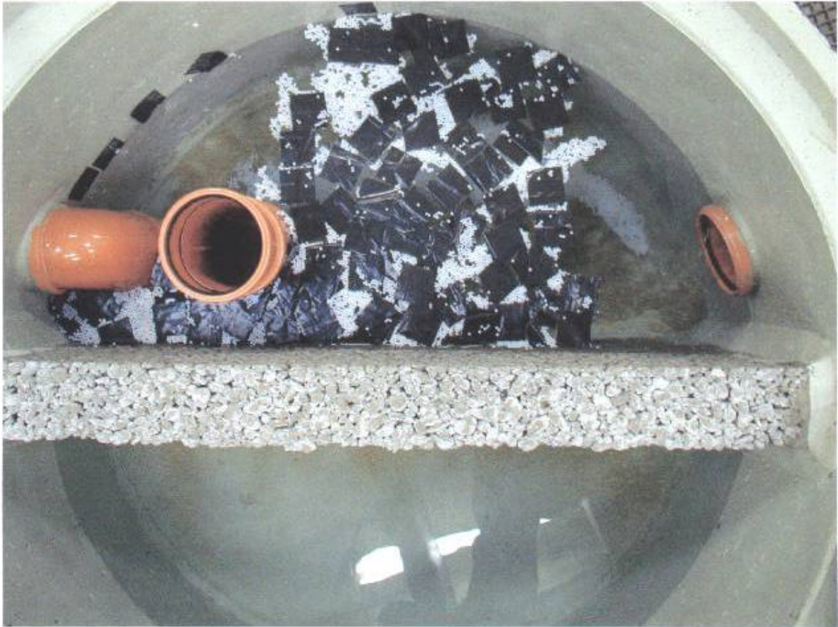
Abbildung 3: Filter bei zufließendem Volumenstrom VQ_{ZU} = 0,19 \text{ l/s} während der Prüfung des Wirkungsgrades des belasteten Filters
